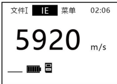
“PE”为脉冲反射超声波测量原理，适用于超声波能以一恒定速度在其内部传播，并能从其背面得到反射的各种材料厚度的测量。
