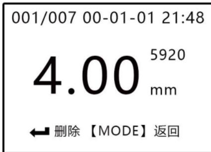
**说明：**001为当前显示的存储数据的序号，007为当前文件中存储数据的总数量，00-01-01为测量年月日，21:48为测量时间，4.00mm为测量厚度值。5920为测量所用的声速。
