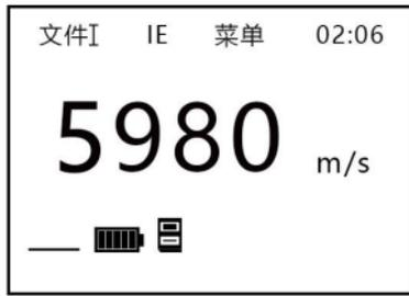
由于测量精度较高，声速的微小变动直接影响测量结果，特别是对于较厚被测物，所以精确测量要求输入精确的声速值。如果对被测物声速不确定，也可以采用“声速校准”章节中的方法取一个相同材质的已知厚度试块来测量声速。另外声速会随温度变化而变化，测
